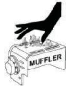
• El motor de este rodillo requiere el flujo adecuado de aire para su enfriamiento. Nunca opere el rodillo en un área cerrada o reducida donde el flujo de aire esté restringido. Si el flujo de aire
